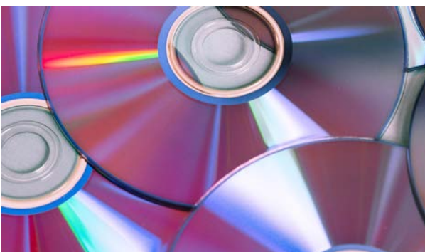
Abb. 84: Neben Musik fassen CD bis zu 900 MB und werden auch heute noch als dauerhaftes Speichermedium verwendet.
