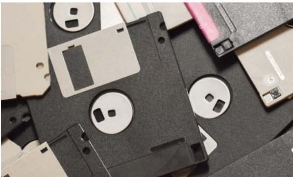
Abb. 83: 1,4 MB passten auf eine Diskette. Ein Bild aus einer Digitalkamera benötigt den 5-fachen Platz.
