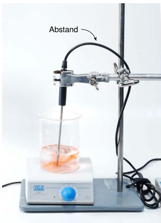
Abb. 58: Sensor in Stativklemme einspannen und Kabel in sichererem Abstand verlegen.
